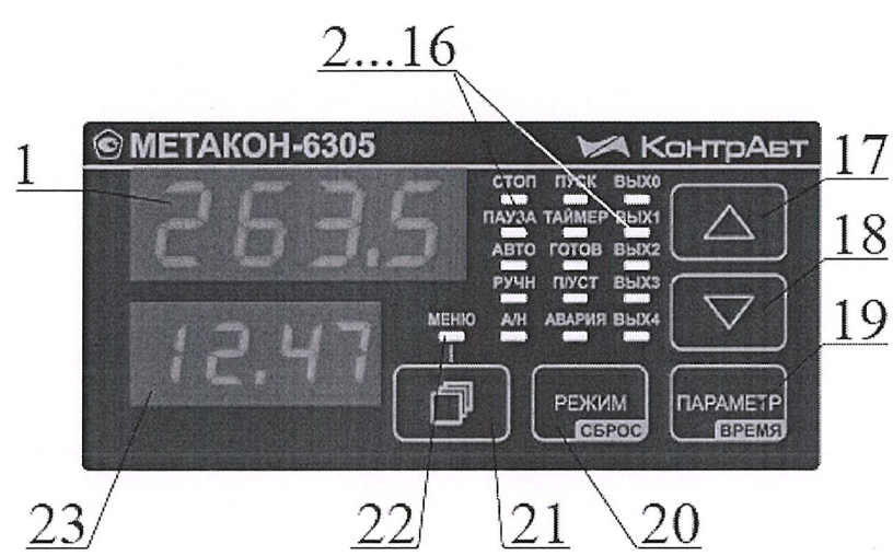
Рисунок 7 – Схема расположения органов управления и индикации на лицевой панели регулятора МЕТАКОН
