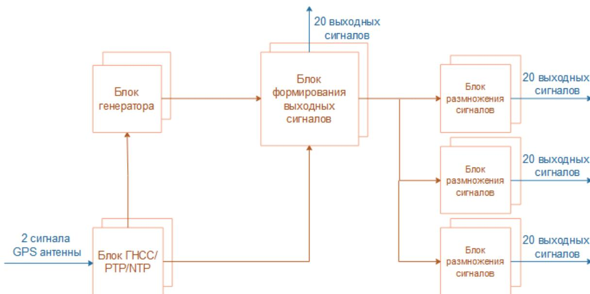
На рис. 11 показан второй вариант. Здесь система ПЭГ состоит из внешнего ПЭИ (первичного эталонного источника), обычно это атомные часы (цезиевые или водородные) и VCH-003, возможно, с блоком ГНСС. Возможны и другие комбинации, например, двое атомных часов и два блока ГНСС.
