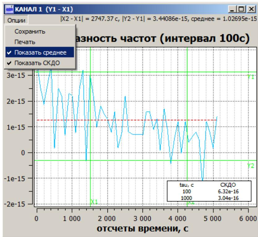
Рисунок 6.5 – График относительной разности частот для интервала времени усреднения 100 с
