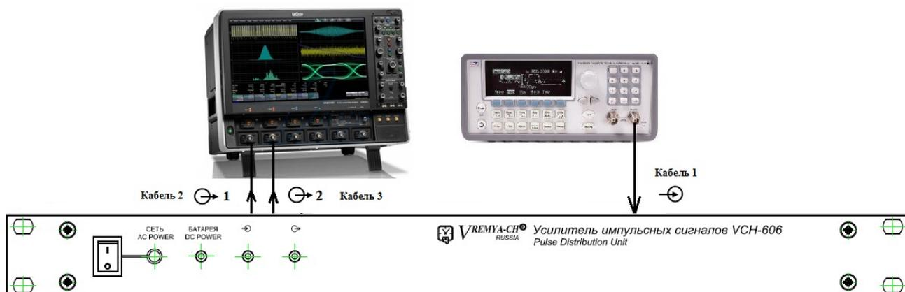
Рисунок 6.4 – Схема соединения приборов для проверки относительной разности задержек рабочих фронтов выходных сигналов
